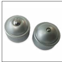
각 5, 10mm 텅스텐볼 인디케이터 STEEL BALL INDENTER : 2EA (TUNGSTEN), 5mm, 10mm
